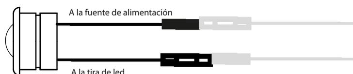
El sensor debe montarse dentro del agujero mientras que la cabeza del sensor debe quedar a la vista para detectar la presencia.
